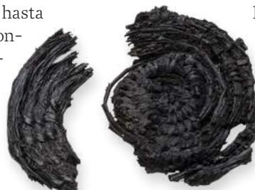
estructura y textura originales. Para ello son congelados en una cámara de la que se extrae el aire, creando el vacío. Este proceso permite que el agua congelada pase a estado gaseoso sin pasar por el estado líquido, para lo cual el vapor que genera este proceso es absorbido por un condensador. De esta forma, la madera se seca sin sufrir deformaciones ni contracciones.
