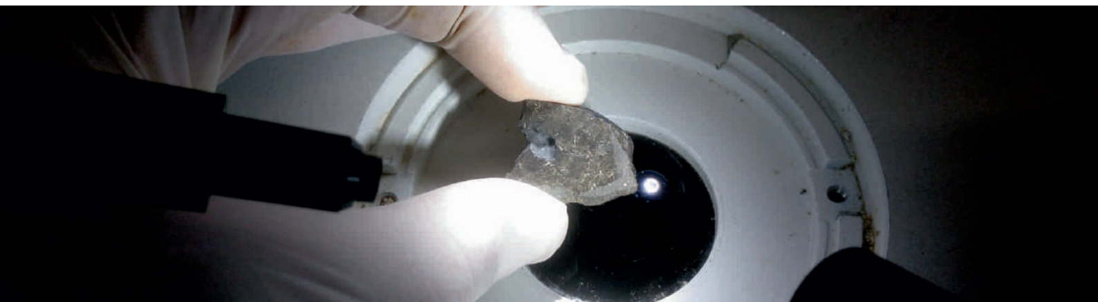
Análisis bajo estereomicroscopio (10X) de la superficie pulida de una muestra pétrea procedente del yacimiento de Carranque. Proyecto nº17.
